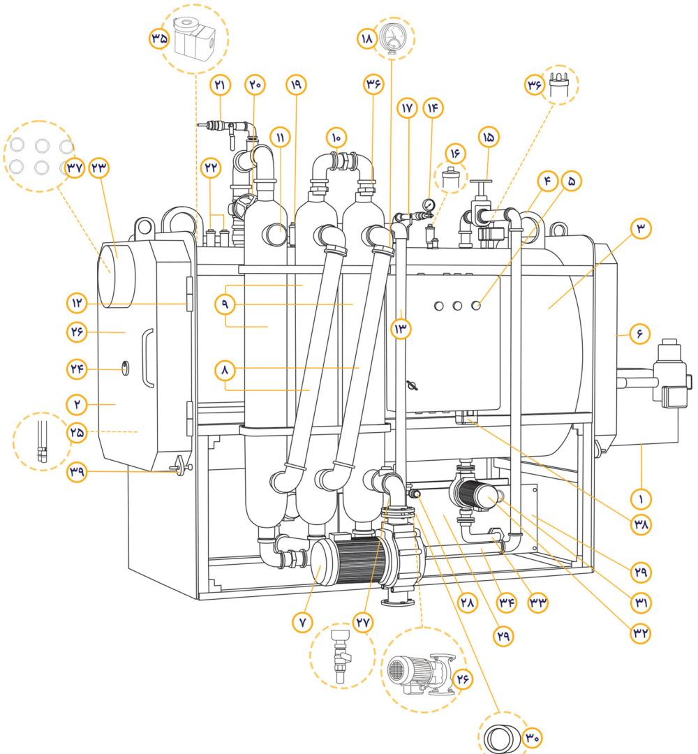
فهرست قطعات تشکیل دهنده پکیج های حرارت مرکزی
